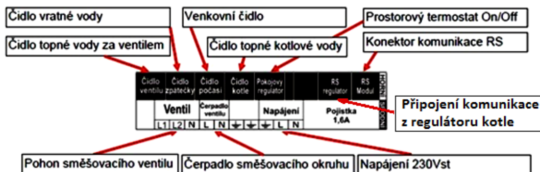
Obr. Schéma zapojení modulu ST-431n.
